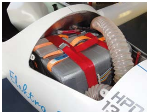
In Folie gepackt und sicher verzurrt: die Kokam-Akkus
