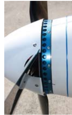
Bewusst hat der Spinner einen geringen Überstand, um Unterdruck zu erzeugen, der die Luft aus dem Motor saugt
