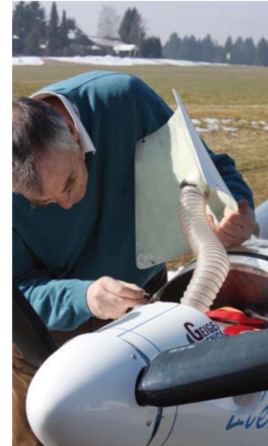
Wer gut kühlt, der gut fliegt! Am Batterieraumdeckel befindet sich der Lufteinlass für den Motorcontroller
