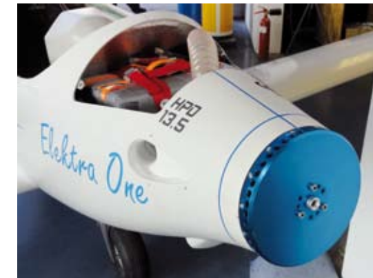
Der rückseitenmontierte Außenläufer von Geiger Engineering leistet kurzzeitig 16 Kilowatt
